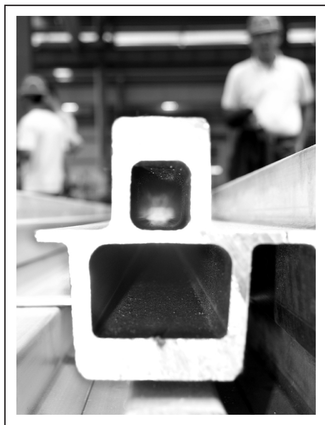
DETTA ÄR DE STÅENDE PROFILERNA TILL VÅRA ALUMINIUMRAMAR DÄR GLASEN SKA LIMMAS I.
