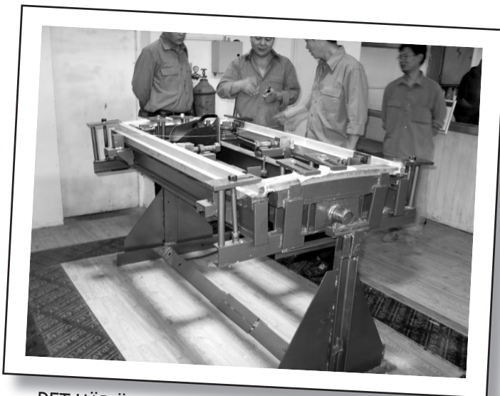
DET HÄR ÄR EN FIXTUR DÄR ALUMINIUMPROFILERNA SVETSAS IHOP TILL EN FÖNSTERRAM.
